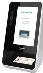
初診・再診窓口カウンターに設置してあるマイナンバーの読取機。
