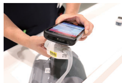
(写真1) モバイル端末をかざすだけで電子カルテへバイタルの自動入力が可能
